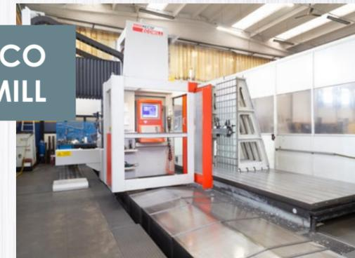
Fresatrice a montante mobile con testa millesimale e velocità di avanzamento a 30 m/min, potenza motore mandrino 30 kW. Dotata di controllo numerico Heidenhain TNC 530. Slittone montato in struttura box-in-box.
